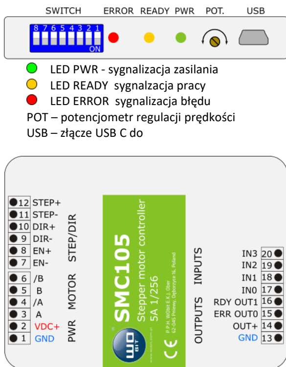
Rysunek 1. Opis złączy i panelu
