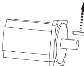
**DE** Bei Motor mit Passfeder muss diese entfernt werden
