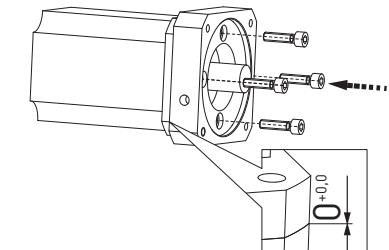
**DE** Adapterplatte an Motor montieren, Schrauben mit der Festigkeitsklasse 8.8 verwenden, Schrauben müssen gesichert werden, Anzugsmoment ( $T_{A,S}$ ) der Schraube: 90% der Schraubenstreckgrenze nutzen, Schrauben mit  $T_{A,U}$  und über Kreuz anziehen
