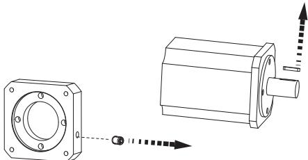
**DE** Abdeckschraube entfernen, bei Motor mit Passfeder muss diese entfernt werden
