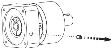
**DE** Abdeckschraube entfernen, Stellung der Klemmschraube justieren
