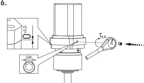
**DE** Motorflansch muss an Getriebeflansch anliegen, Klemmring mit  $T_{A,K}$  anziehen, Abdeckschraube einschrauben
