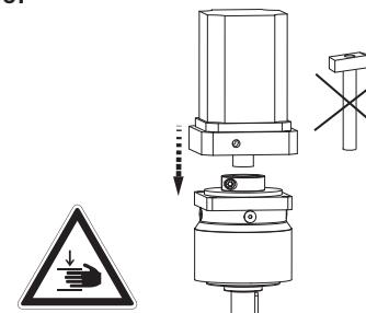
**DE** Stellung der Klemmschraube justieren, Klemmschraube öffnen, d\_Motor < d\_Hohlwelle: Buchse verwenden, Motormontage bevorzugt in vertikaler Position, Motor in Getriebe fügen
