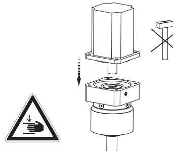
**DE** Klemmschraube öffnen,  $d_{Motor} < d_{Hohlwelle}$ : Buchse verwenden, Motormontage bevorzugt in vertikaler Position, Motor in Getriebe fügen
