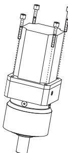
**DE** Schrauben mit der Festigkeitsklasse 8.8 verwenden, Schrauben müssen gesichert werden; Anzugsmoment ( $T_{A,S}$ ) der Schraube: 90% der Schraubenstreckengrenze nutzen, Schrauben mit  $T_{A,S}$  und über Kreuz anziehen
