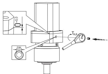
**DE** Motorflansch muss an Getriebeflansch anliegen, Klemmring mit  $T_{A,K}$  anziehen, Abdeckschraube einschrauben
